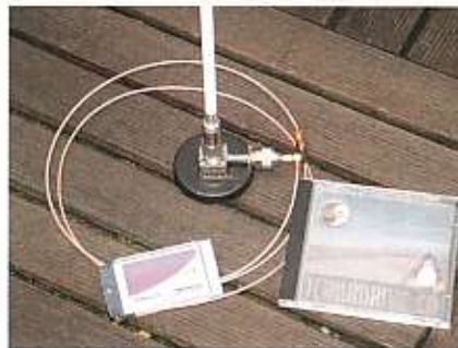
Aansluiten van de antenne op de 'Main' antenne poort van de Senao PCMCIA kaart.
